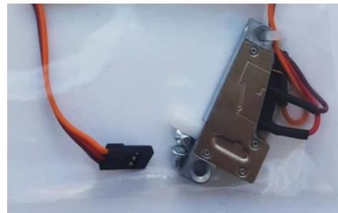
Abbildung 1: Sabotagekontakt mit Kabel
